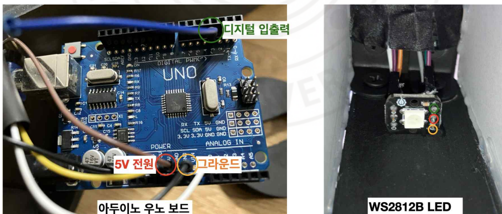
[그림-15] DIMENSION에 장착된 아두이노 우노 보드와 LED
