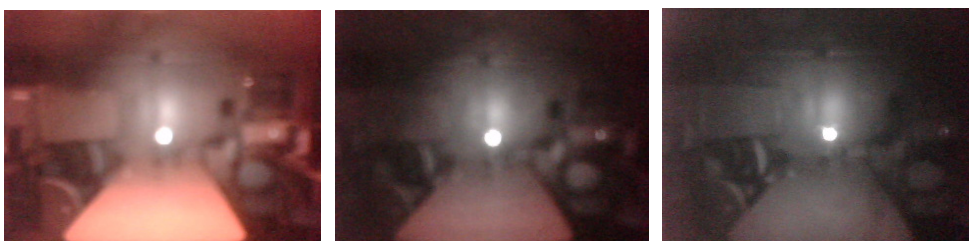
[그림-11] 네거티브 필름 한 장(좌), 두 장(가운데), 세 장(우) 사용했을 때의 화면 비교
