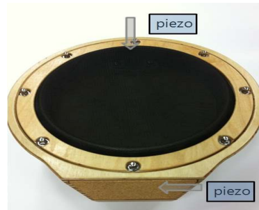
그림 5. 데이터 혼선 방지를 위한 피에조의 위치 분리
