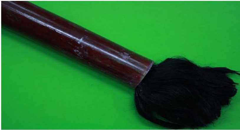
[그림-19] Wii Remote를 넣어 제작한 붓
