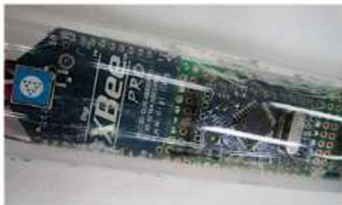
[그림-27] Digital Stick에 부착된 XBee와 Arduino Mini
