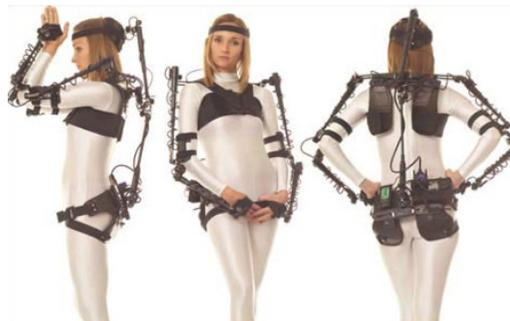
[그림-2] 기계식 모션 캡처 시스템
