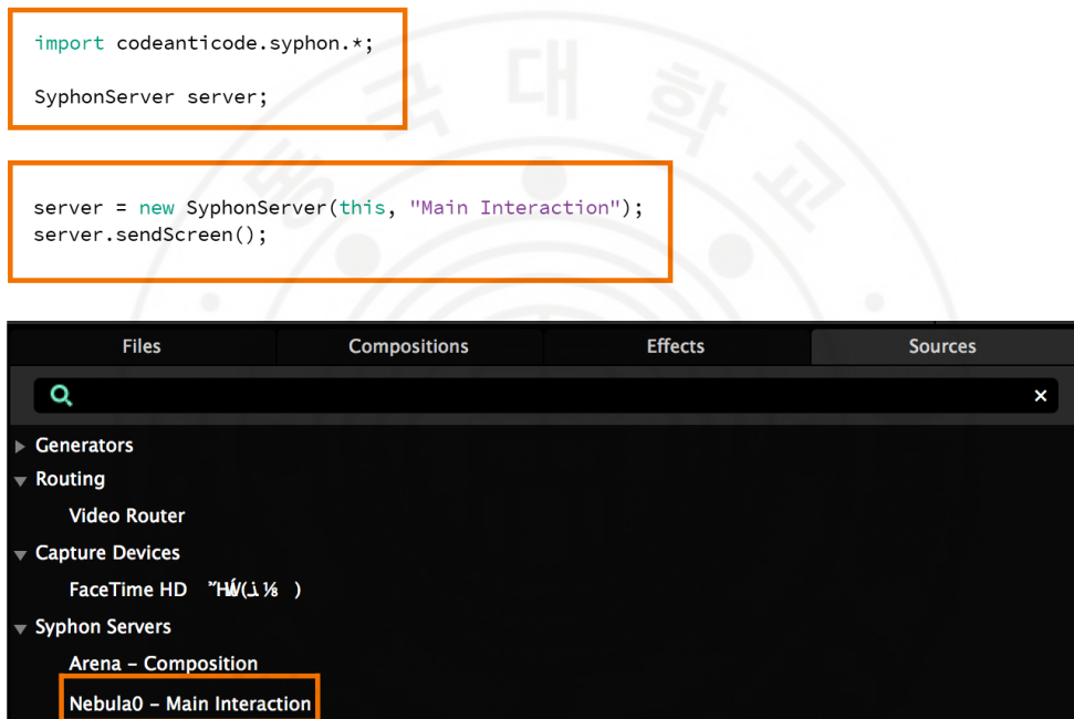
[그림-34] Syphon을 이용한 Processing과 Arena의 연동
