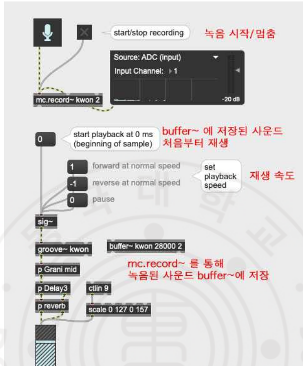
[그림-26] 보잉 사운드 녹음을 위한 mc, record~를 이용한 Max 패치
