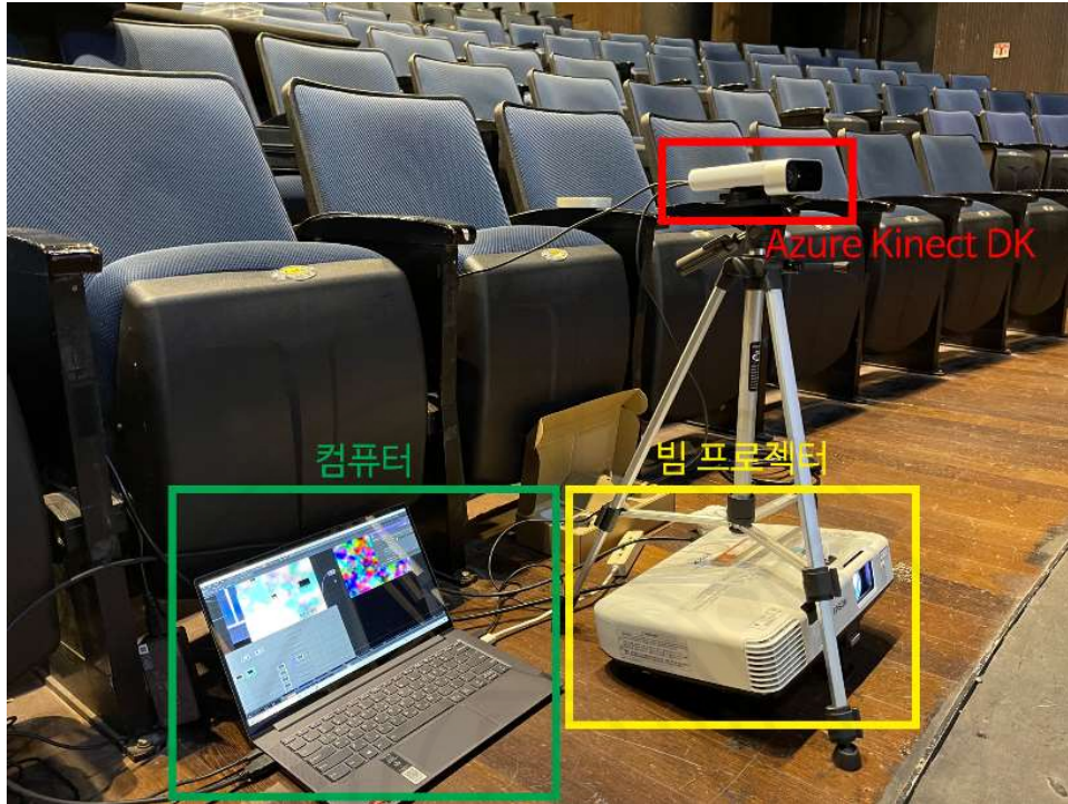
[그림-24] Azure Kinect DK와 빔 프로젝터, 컴퓨터 배치 사진
