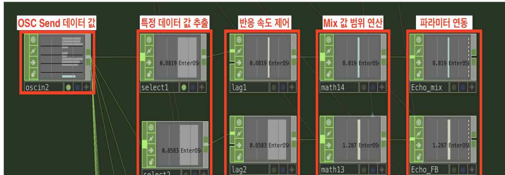
[그림-39] Ableton Live에서 터치디자이너 파라미터로 연동하는 시스템
