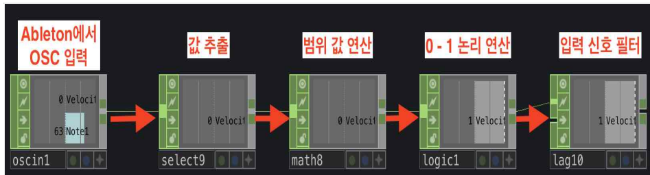
[그림-34] OSC 신호를 0-1 신호로 전환하기 위한 시스템
