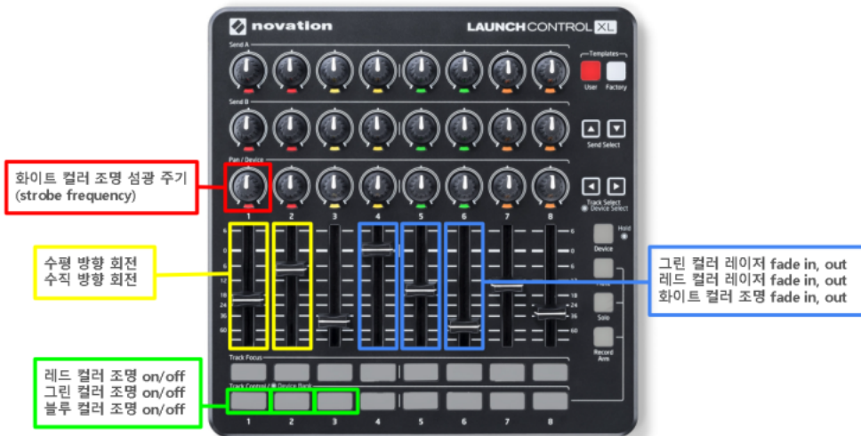
[그림-44] 공연에서 사용한 Novation Launch Control XL의 미디 맵핑
