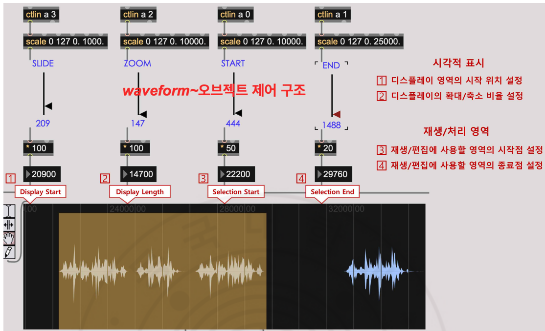
[그림-8] waveform~ 제어 구조
