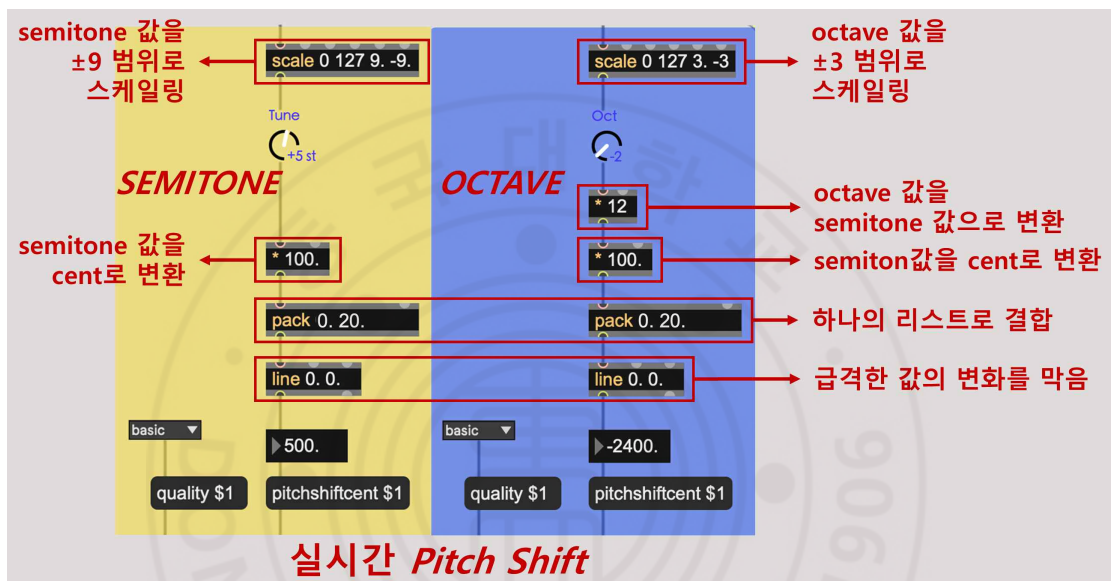
[그림-15] 실시간 기반 pitch shift Max/MSP 패치
