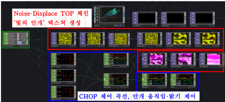
[그림-20] Noise·Displace TOP 을 이용한 빛의 질감 생성 패치
